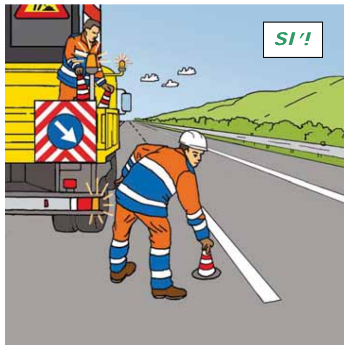
Figura 59 – Posizionamento dei coni o defleco: comportamento corretto
