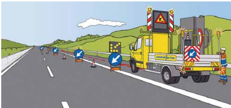
Figura 32 – Chiusura della corsia di marcia: installazione della testata di esclusione della corsia
